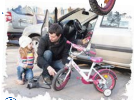
2 Подкачай колёса насосом. Прокрути их. Колесо не должно влиять из стороны в сторону и скрипеть.
