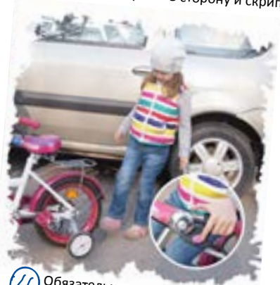
2 Подкачай колёса насосом. Прокрути их. Колесо не должно влиять из стороны в сторону и скрипеть.
